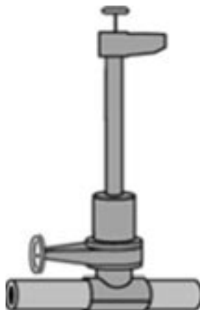
2. Przyrząd do nawiercania zamontowany na trójniku półkulkowym skręcanym i zasuwie odcinającej /Mechanical Fittings/
