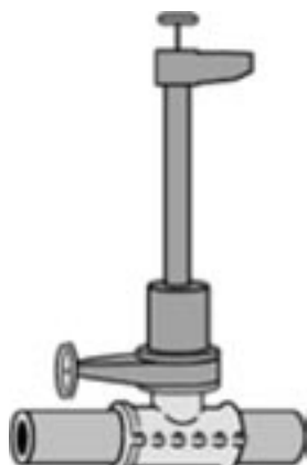
1. Przyrząd do nawiercania zamontowany na trójniku półkulkowym spawanym i zasuwie odcinającej
