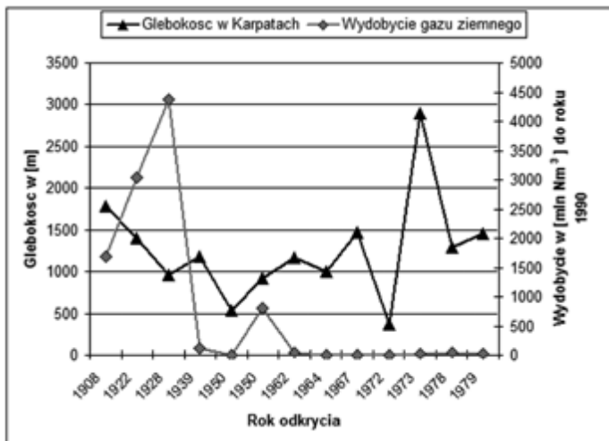
Rys. 1 Regres wydobywania gazu ziemnego w porównaniu do wzrastającej głębokości poziomów gazonośnych (opracowanie własne, źródło [8]).
