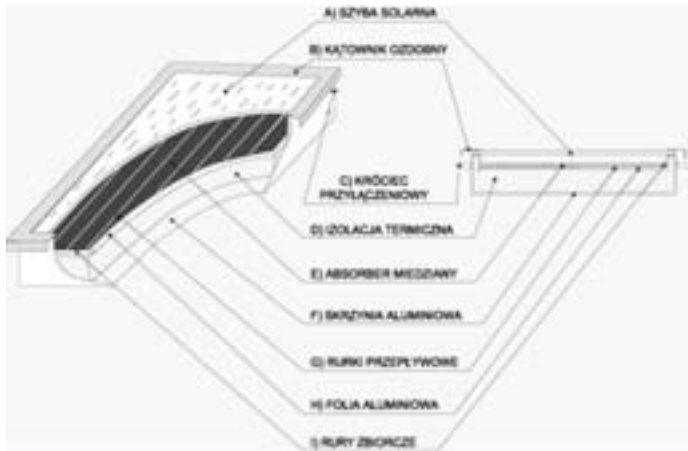
Rys.1.13. Przykład przekrój kolektora słonecznego najczęściej stosowanego w Jordanii
